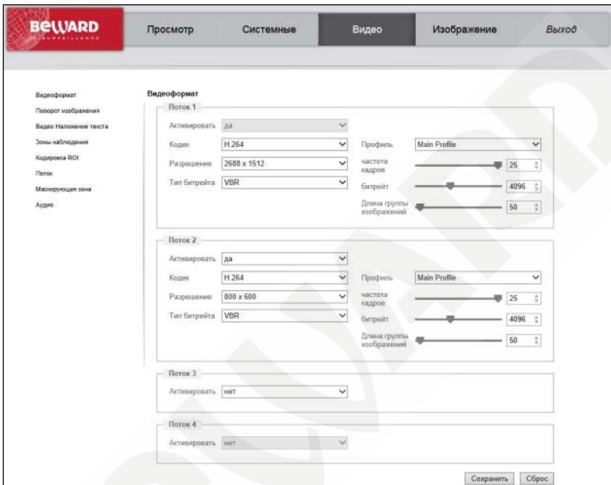
**Видеоформат (Video Format):** настройка формата кодирования, разрешения, вывода титров, преобразования изображения.
