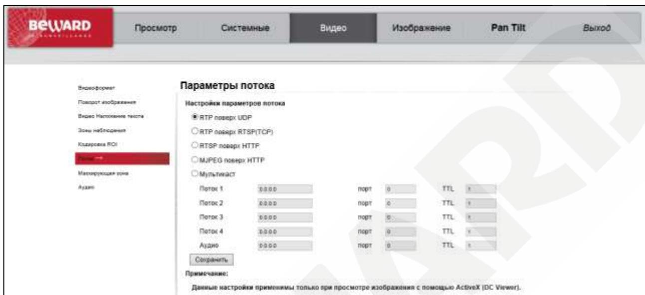
**RTP поверх UDP (RTP over UDP):** трансляция видео по протоколу RTP поверх протокола UDP. При выборе данного формата видео передается в потоковом формате без подтверждения приема пакетов. Такой формат передачи данных следует использовать только при работе камеры в слабо загруженных локальных сетях. Для передачи видео через Интернет такой формат вещания непригоден, так как большинство провайдеров фильтруют UDP пакеты и, кроме того, процент потерь таких пакетов в публичных сетях очень велик.
